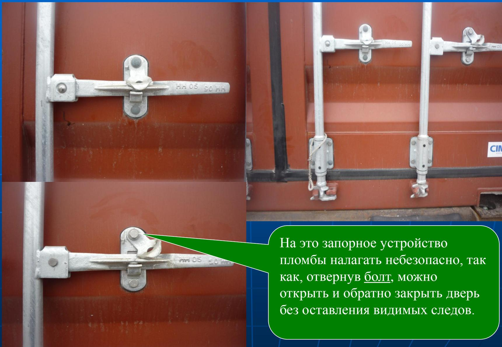
На это запорное устройство пломбы налагать небезопасно, так как, отвернув болт, можно открыть и обратно закрыть дверь без оставления видимых следов.
