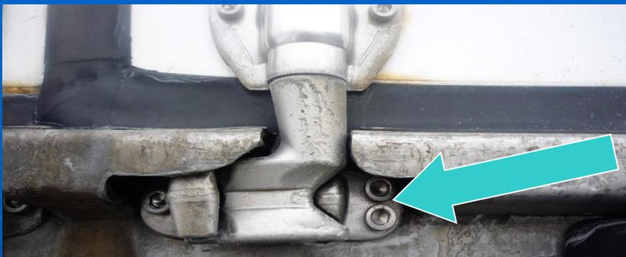
Детали крепления системы запирания должны быть деформированы сваркой для исключения наложения приспособлений для их снятия
